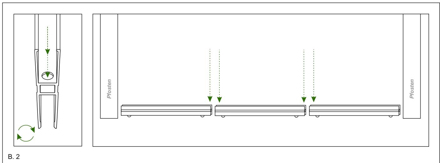
3. Setzen Sie den Einsatz von der Unterseite des H-Profils ein. Achten Sie darauf, dass das Gewinde mit der breiteren Öffnung nach vorne zeigt.
